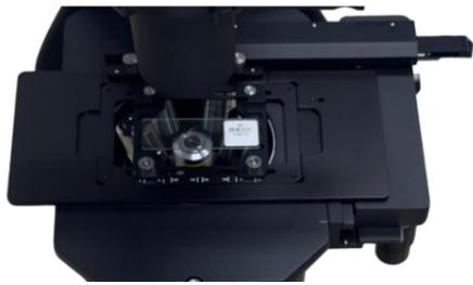
机械移动尺：行程：129 (X) × 83 (Y)，兼容五种微型实验板、多孔板夹和载物台夹，标配带通用托板；适用于 Terasaki 板、载玻片、 $\Phi 35-65$  培养皿 •  $\Phi 35$ mm 培养皿等多种托架。
